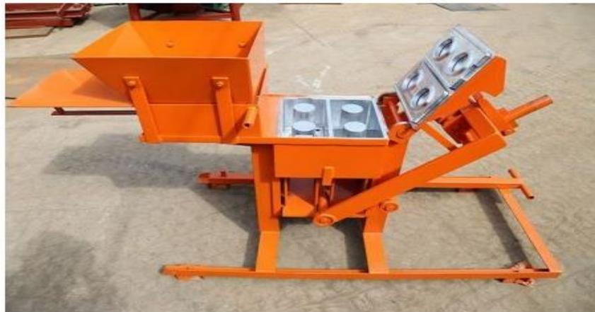
*Figura 5:* Molde de ladrillos ecológicos . Recuperado por:
