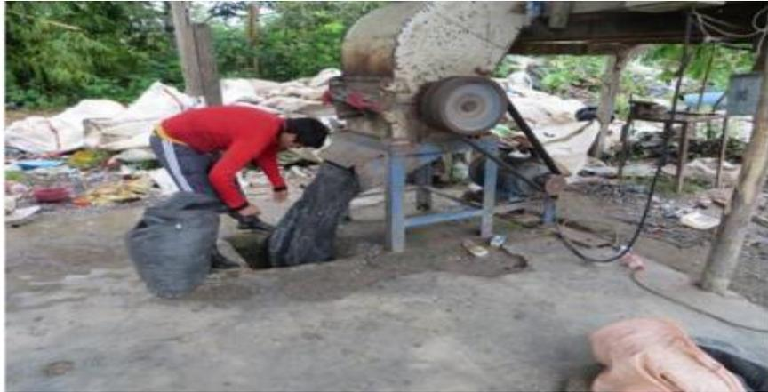
*Figura 4:* trituradora industrial de botellas. Recuperado por:[http://repositorio.unapiquitos.edu.pe/bitstream/handle/UNAP/4363/Alfonso\\_Tesis\\_Titulo\\_2016.pdf?sequence=1&isAllowed=y](http://repositorio.unapiquitos.edu.pe/bitstream/handle/UNAP/4363/Alfonso_Tesis_Titulo_2016.pdf?sequence=1&isAllowed=y)
