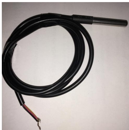
Figura 109. Sensor de temperatura DS18B20 tipo sonda. Fuente: Elaboración propia.
