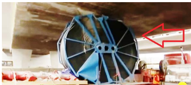
Figura 6. Vista fotográfica donde se aprecia la carga (faja transportadora) aplastada y con pérdida de simetría producto del fuerte impacto contra el techo del puente.
