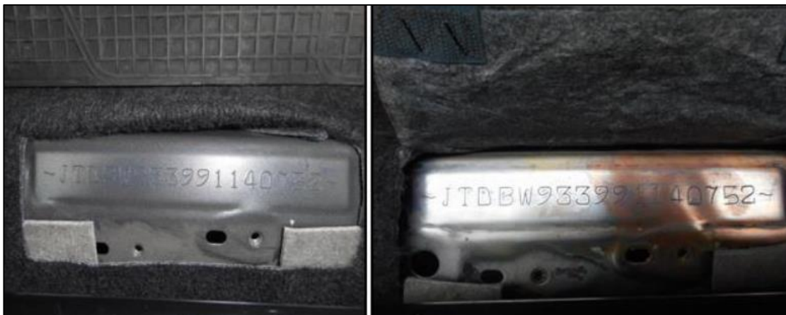
Figura 9. Vehículos con códigos de identificación similares (izquierda es original y el de la derecha es regrabado en vehículo “clonado” con marcación serial original modificada. Fuente: (Zapata, 2017, pág. 13)
